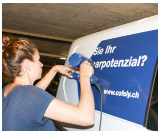
Mithilfe eines Föhns (Mitte) befreit Flurina Morf den Ford Transit von seinem alten Gewand (links), ehe die neue Folierung zentimetergenau angebracht wird (rechts).
