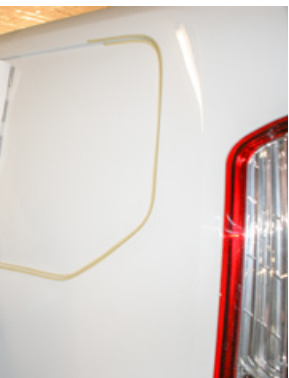
Nachdem die Schutzfolie entfernt ist, schneidet Braun die Folie auf den Kanten der Blindfenster millimetergenau zu, ohne den darunterliegenden Lack zu beschädigen.
