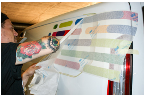
Nachdem die Schutzfolie entfernt ist, schneidet Braun die Folie auf den Kanten der Blindfenster millimetergenau zu, ohne den darunterliegenden Lack zu beschädigen.
