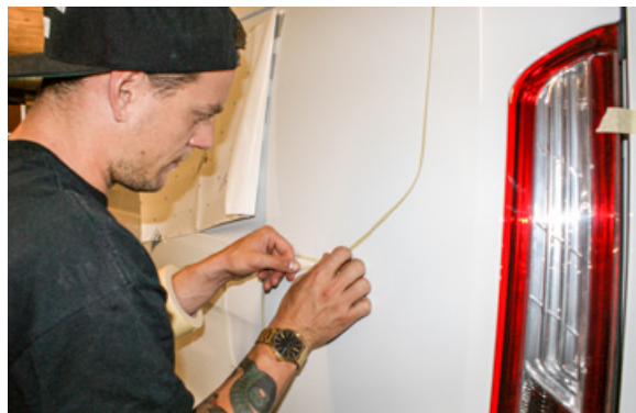
Mario Braun säubert den Lack von alten Folienrückständen (links), ehe er das Konturband anbringt (Mitte) und anschliessend die neue Folierung aufträgt.
