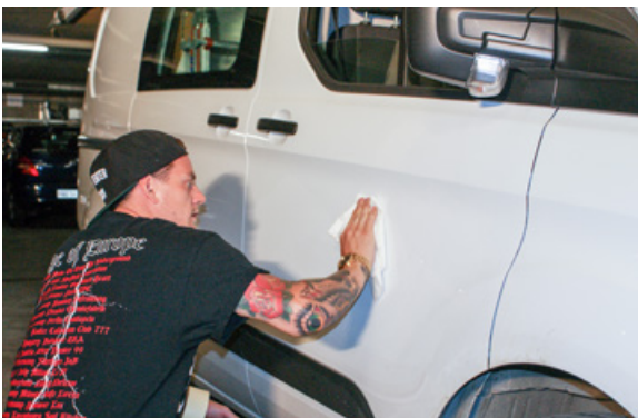
Mario Braun säubert den Lack von alten Folienrückständen (links), ehe er das Konturband anbringt (Mitte) und anschliessend die neue Folierung aufträgt.
