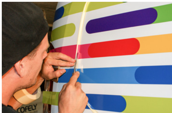
Nachdem die Schutzfolie entfernt ist, schneidet Braun die Folie auf den Kanten der Blindfenster millimetergenau zu, ohne den darunterliegenden Lack zu beschädigen.
